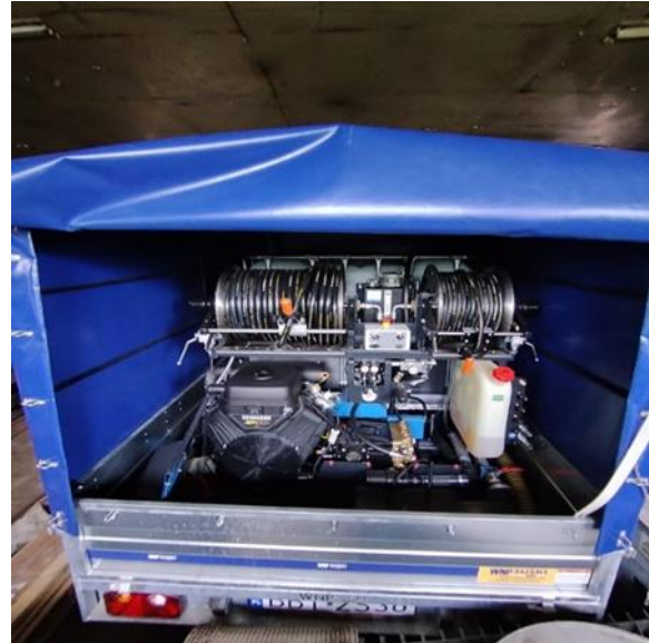
Wysokociśnieniowe urządzenie do czyszczenia kanalizacji PYTON 3.0 150/85
